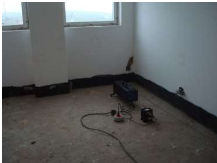
Figura C.1 – Fonte sonora no ponto C1, localizada na Suíte de Ensaio (piso de ensaio – pavimento superior).
